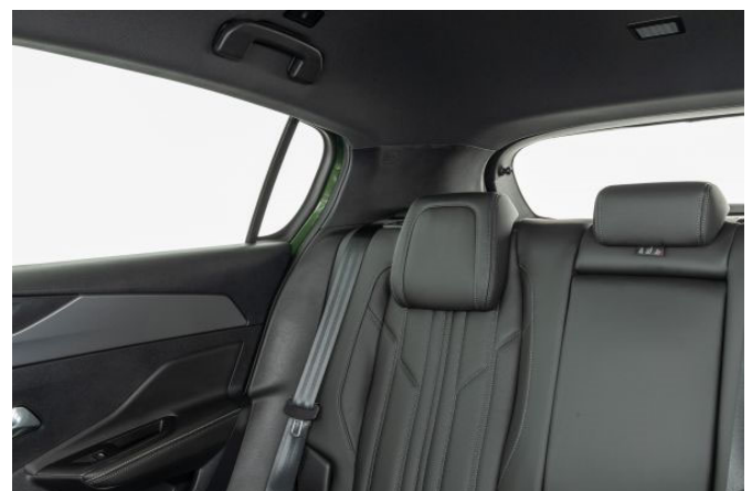
Breite Dachsäulen und nicht vollständig versenkbare Kopfstützen schränken die Sicht nach hinten ein.
