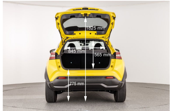
Die 78 cm hohe Ladekante macht das Be- und Entladen des Kofferraums zu einer mühsamen Tätigkeit.
