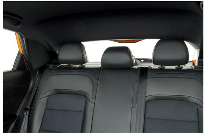
Die sehr breiten Dachsäulen und die nicht versenkbaren Fondkopfstützen schränken die Sicht nach hinten erheblich ein.
