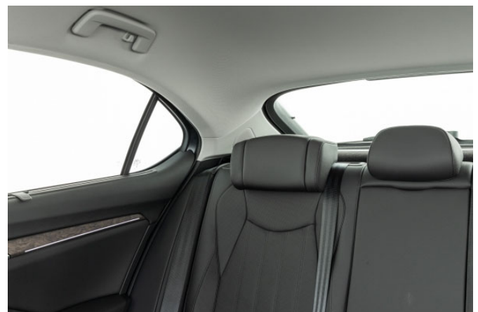
Die breiten Dachsäulen und die nicht vollständig versenkbaren Kopfstützen schränken die Sicht nach hinten ein.
