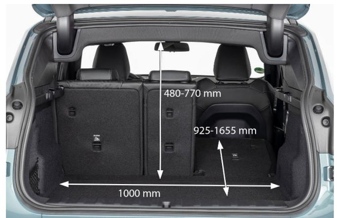
Unter der Kofferraumabdeckung bietet der X2 395 l Kofferraumvolumen. Entfernt man diese, passen bis zum Dach 515 l hinein.
