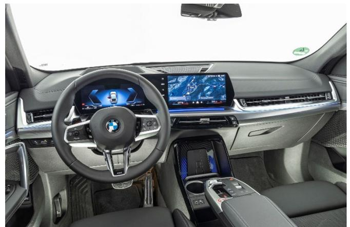
Die Verarbeitungsqualität ist gut, auch durch die Aufwertung des Innenraums mit dem aufpreispflichtigen M Sportpaket. Das geliebte iDrive-Konzept fiel dem Rotstift zum Opfer - im X2 wird wahlweise via Touch, weniger verbliebener Tasten, oder Sprachbedienung interagiert.
