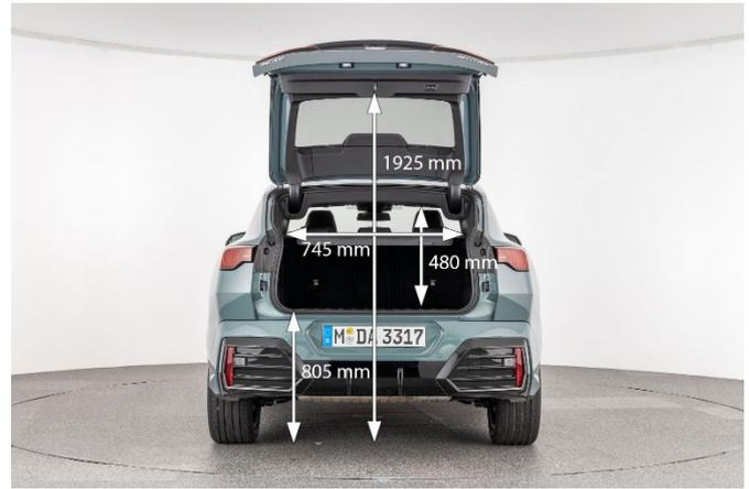
Die Ladekante liegt mit über 80 cm sehr hoch über der Fahrbahn und erschwert das Ein- und Ausladen deutlich.
