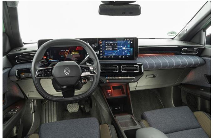
Sowohl die Verarbeitungsqualität im Innenraum als auch die Materialanmutung wissen zu gefallen. Die Menüstruktur des Bediensystems ist weitgehend logisch aufgebaut, allerdings hat es Renault mit drei Lenkstockhebeln auf der rechten Lenkseite schlicht übertrieben.
