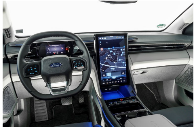
Die primäre Bedienung des Fahrzeugs erfolgt über ein höhen- und neigungsverstellbares 14,6-Zoll-Zentraldisplay; zusätzliche Funktionen werden über Lenkradtasten, ein 5,3-Zoll-Fahrerdisplay und Touch-Bedienelemente an der Mittelkonsole sowie den Türen gesteuert, wobei physische Tasten weitgehend entfallen.
