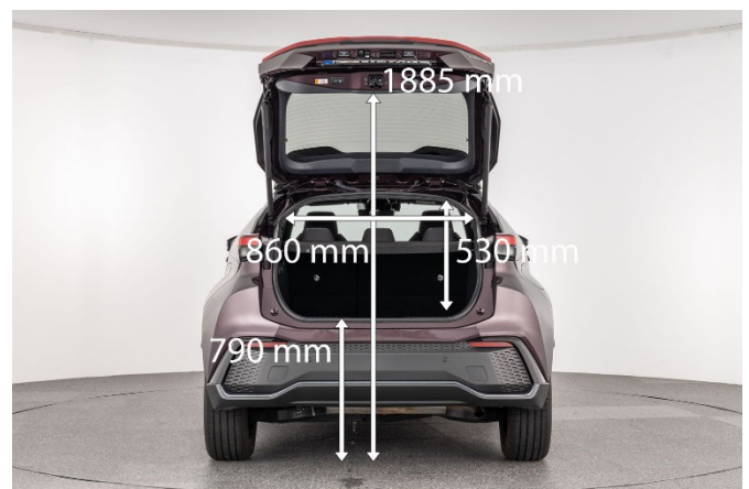
Der Kofferraum der Lounge-Variante verfügt über eine elektrische Heckklappe mit anpassbarer Öffnungshöhe. Leider missfällt die hohe Ladekante mit 79 cm und die Stufe von 5 cm zwischen Ladefläche und Bordwand.
