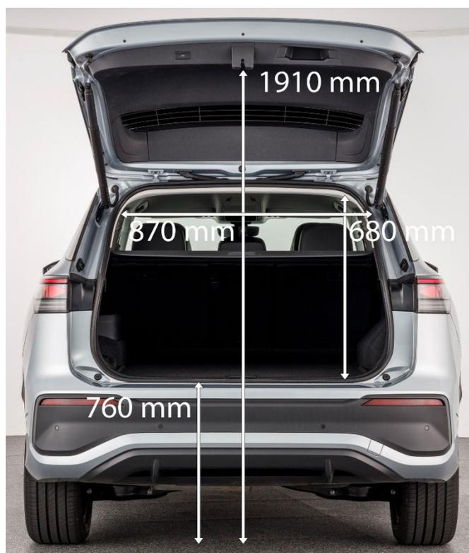
Serienmäßig muss man die Heckklappe manuell bedienen. Gegen Aufpreis erhält man sie elektrisch angetrieben, dann lässt sich auch die Höhe beschränken - praktisch beispielsweise in Tiefgaragen. Unpraktisch dagegen ist die hohe Ladekante von 76 cm.
