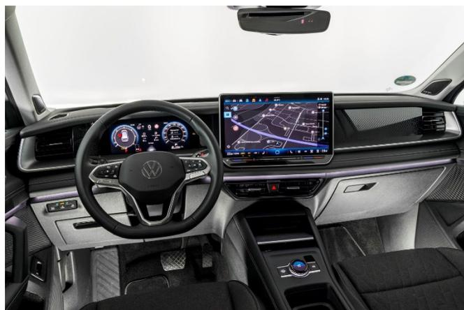
Der VW Tayron verfügt über ein Infotainmentsystem mit einem optionalen 15-Zoll-Display und mechanische Tasten am Lenkrad. Der Blinkerhebel ist mit vielen Funktionen überladen worden.
