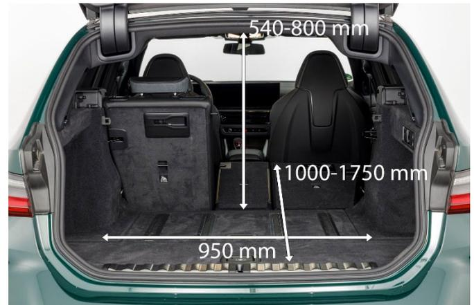
Das Ladevolumen entspricht den Erwartungen an einen Mittelklasse-Kombi. Gummielemente in den länglichen Edelstahlleisten sichern die Ladung raffiniert.
