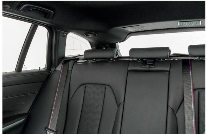
Die Rundumsicht ist trotz nicht allzu wuchtiger Dachsäulen nur ausreichend. Die Kopfstützen lassen sich für eine bessere Sicht umklappen.
