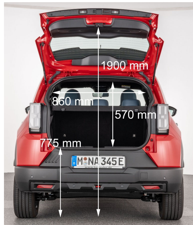
Die Ladekante macht mit ca. 78 cm Höhe das Be- und Entladen zu einer mühsamen Tätigkeit.
