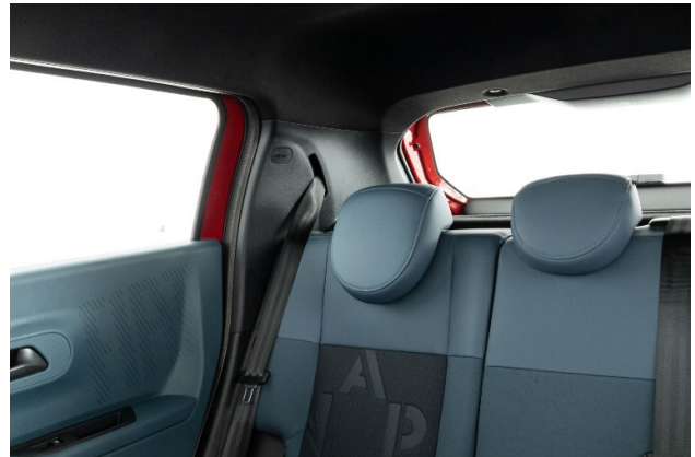
Sehr breite Dachsäulen und der hohe Heckabschluss erschweren die Sicht nach hinten.
