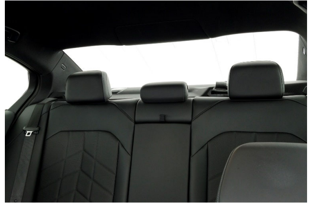
Die Sicht nach hinten wird durch die nicht versenkbaren Kopfstützen und die breiten C-Säulen erschwert. Die serienmäßige Rückfahrkamera ist da eine große Hilfe.
