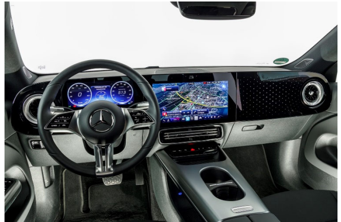
Das Bedienkonzept des CLA setzt auf einen zentralen, hochauflösenden 14-Zoll-Touchscreen und ein 10,25-Zoll-Fahrerdisplay, wobei physische Bedienelemente weitgehend durch Touchflächen am Lenkrad und in den Menüs ersetzt wurden.
