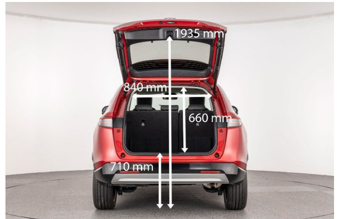
Die elektrische Heckklappe öffnet ausreichend hoch für rund 1,95-m-Personen. Im Inneren des Honda entsteht beim Umklappen der "Magic Seats" ein komplett ebener Ladeboden.
