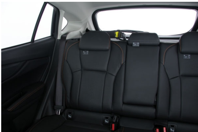
Breite Dachsäulen und die hohe Fensterlinie verhindern eine gute Sicht nach schräg hinten.
