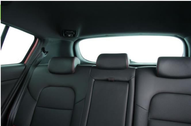
Nur z.T. versenkbare Fondkopfstützen und breite Dachsäulen schränken die Sicht nach hinten ein.
