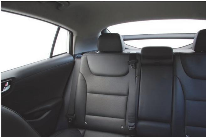
Die Sicht nach hinten wird durch die breiten Dachsäulen, die nicht versenkbaren Kopfstützen und die kleine, durch den Heckspoiler geteilte Heckscheibe extrem eingeschränkt.
