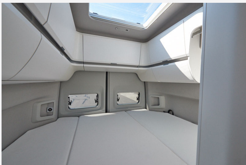
Durch die Karosserieverbreiterungen konnte VW ein Querbett realisieren
