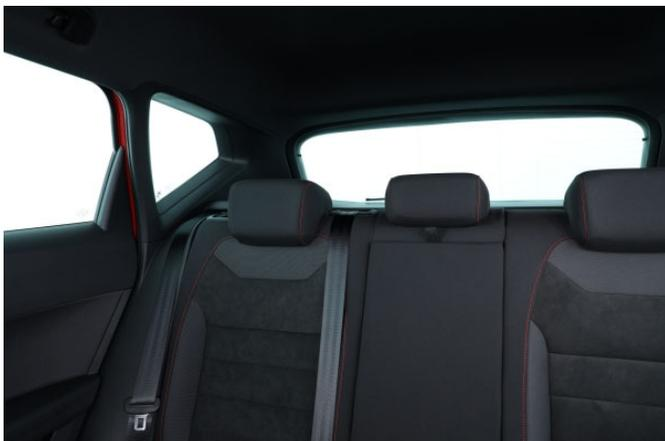
Breite Dachsäulen im Heckbereich schränken die Sicht nach schräg hinten stark ein.
