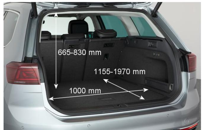
Aufgrund der verbauten Hybridkomponenten ist der Kofferraum (395 l Volumen) des Passat GTE um 80 l kleiner als beim herkömmlich angetriebenen Passat-Modellen.
