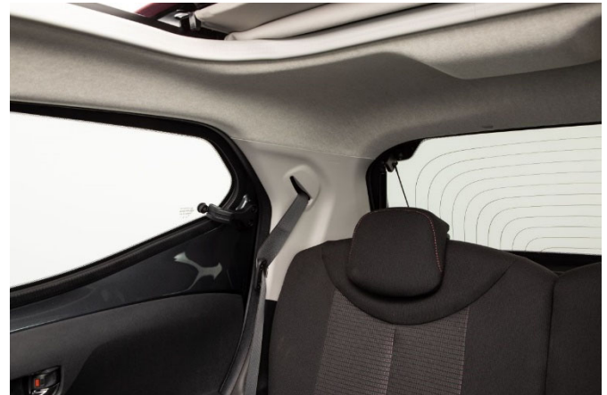
Die breiten Dachsäulen schränken die Sicht nach schräg hinten ein.
