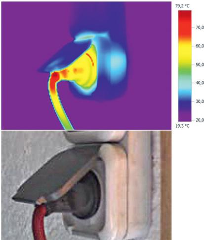
Zur Veranschaulichung: Bild links zeigt eine Standardausrüstung mit einer 230 V Steckdose und einem Verlängerungskabel mit 1,5 mm<sup>2</sup> Leiterquerschnitt. Das Thermographiebild (oben) zeigt nach 30 Minuten Laden eines E-Fahrzeuges mit 16 A die gefährliche Erwärmung des Kabels und Steckers.
