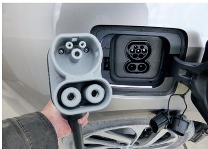
Bei japanischen E-Mobilen ist fahrzeugseitig meist der Typ 1-Stecker verbaut. Dieser ermöglicht 1-phasiges Laden theoretisch bis zu 7,2 kW. Netzseitig erlaubt sind einphasig nur 4,6 kW. Typ 1-Stecker-Fahrzeuge können mit dem geeigneten Ladekabel auch an Typ 2-Ladestationen geladen werden. In vielen Fällen wird zusätzlich zum Typ 1-Stecker eine Schnelllademöglichkeit nach dem japanischen Standard CHAdeMO (DC-Ladung bis zu 50 kW) angeboten.
