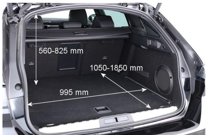
Mit 435 l Volumen ist der Kofferraum des Peugeot 508 SW Hybrid für einen Kombi von klassenüblicher Größe. Nachteile gegenüber den herkömmlich angetriebenen Varianten bestehen nicht.
