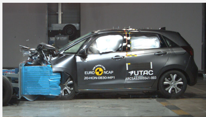
Der Honda Jazz im frontalen Offsetcrash gegen die rollende Barriere mit Deformationselement (Foto: Euro NCAP)
