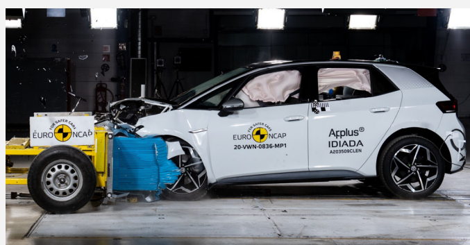
Der VW ID.3 im frontalen Offsetcrash gegen die rollende Barriere mit Deformationselement (Foto: Euro NCAP)
