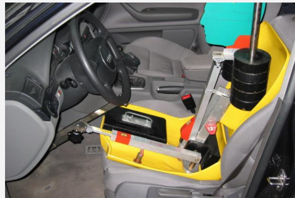
Mit einer Messpuppe werden im ADAC Autotest die Platzverhältnisse genau vermessen und dokumentiert. Foto: ADAC/FTT
