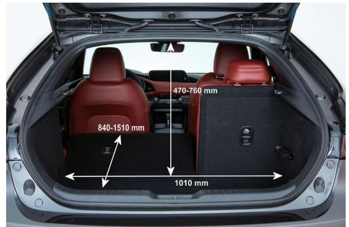
Mit 325 l Volumen ist der Kofferraum des Mazda 3 für ein Fahrzeug der unteren Mittelklasse von durchschnittlicher Größe.
