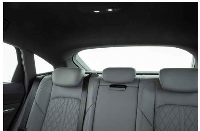
Breite Dachsäulen und nicht vollständig versenkbare Kopfstützen beeinträchtigen die Sicht nach hinten.
