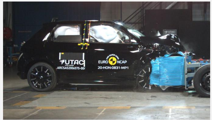
Der Honda e im frontalen Offsetcrash gegen die rollende Barriere mit Deformationselement (Foto: Euro NCAP)
