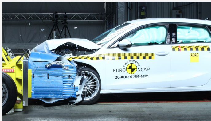
Der Audi A3 im frontalen Offsetcrash gegen die rollende Barriere mit Deformationselement (Foto: Euro NCAP)
