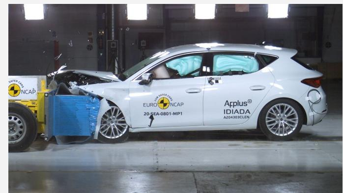
Der SEAT Leon im frontalen Offsetcrash gegen die rollende Barriere mit Deformationselement (Foto: Euro NCAP)
