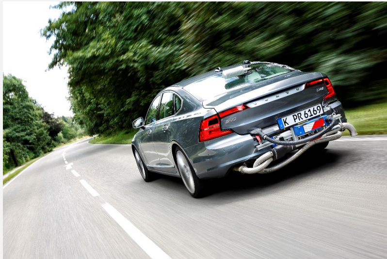
Fahrzeug mit mobiler Abgasmessanlage (PEMS)
