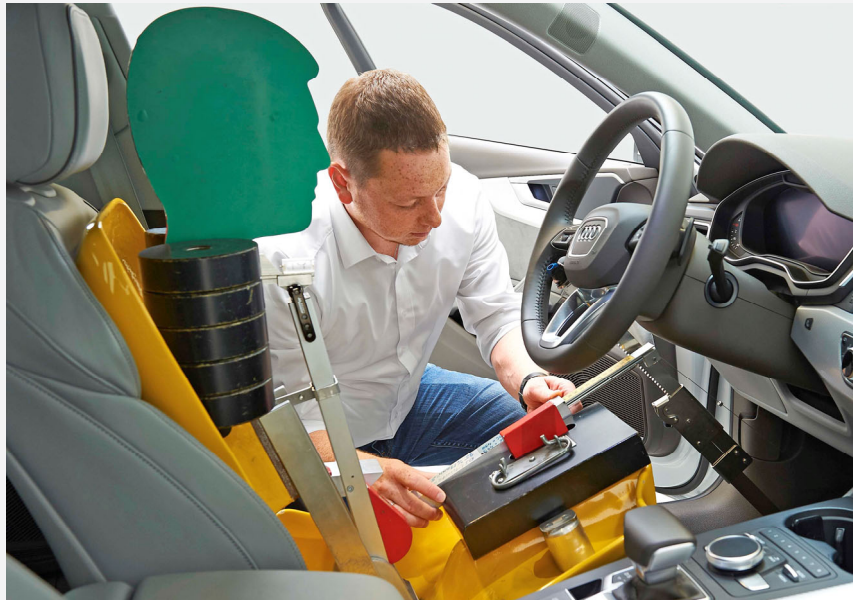
Messpuppe zur Ermittlung der Innenraummaße
