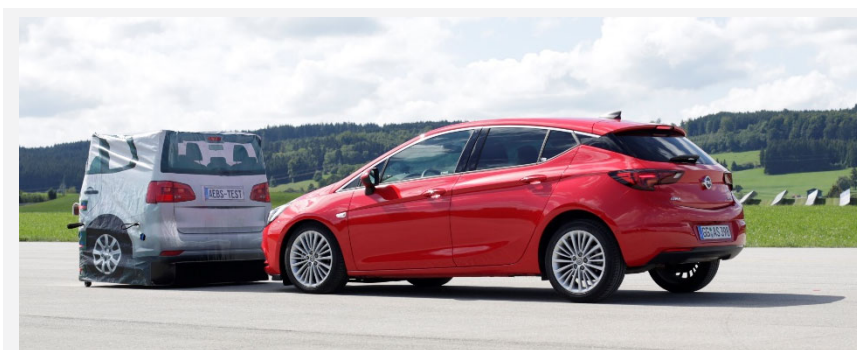
Testaufbau für Notbremsassistent (Sondertest)
