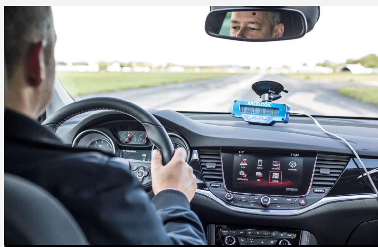
Fahrleistungsmessungen mittels GPS-Messsystem
