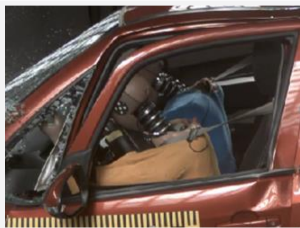
115 ms: Maximale Belastung des Fahrers durch Lenkrad und Armaturenbrett. Türe und A-Säule knicken aus.
