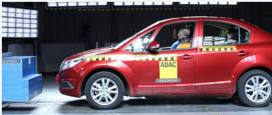
Versuchsaufbau vor Crash
