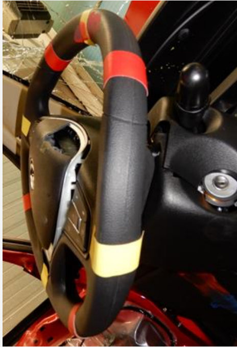
Lenkrad mit Deformationen und Beschädigungen durch Kopf und Brust
