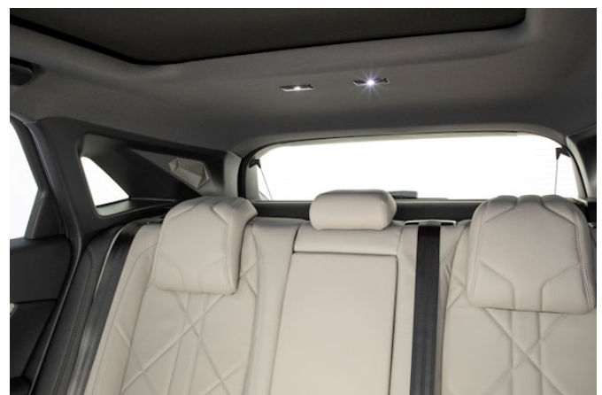
Die breiten Dachsäulen und die schmale, hoch ansetzende Heckscheibe schränken die Sicht nach hinten ein.
