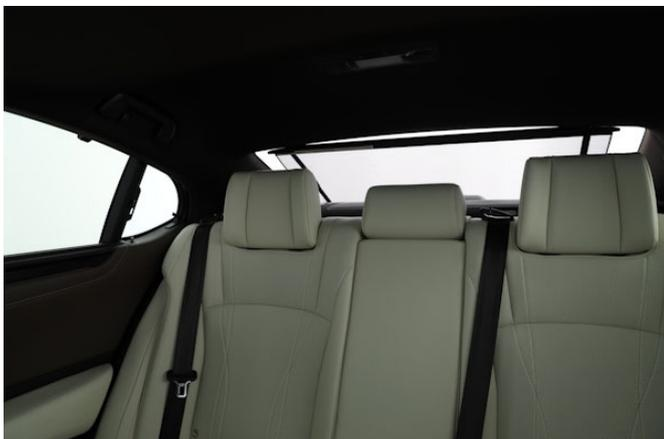
Breite Dachsäulen, nicht versenkbare Kopfstützen und die schmale, hoch ansetzende Heckscheibe schränken die Sicht erheblich ein.
