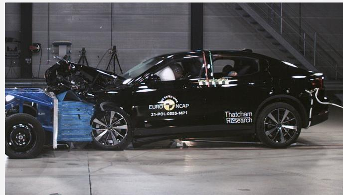
Der Polestar 2 im frontalen Offsetcrash gegen die rollende Barriere mit Deformationselement (Foto: Euro NCAP)
