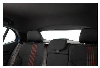
Breite Dachsäulen und die nicht versenkbaren äußeren Kopfstützen im Fond behindern die Sicht nach schräg hinten enorm.
