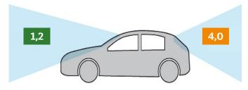
Die Scheinwerfer beleuchten beim Verlassen des Fahrzeugs für eine gewisse Zeit das Umfeld. Diese Funktion kann auch mittels separater Taste auf der Fernbedienung aktiviert werden.
