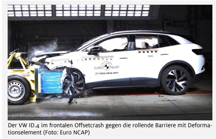
Der VW ID.4 im frontalen Offsetcrash gegen die rollende Barriere mit Deformationselement (Foto: Euro NCAP)
