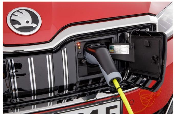
Muss der Superb nachgeladen werden, so befindet sich der nötige Ladeanschluss integriert im Kühlergrill.
