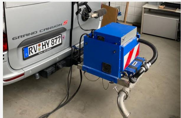
Die mobile Abgasmessanlage am Hymer. (Foto: ADAC)
