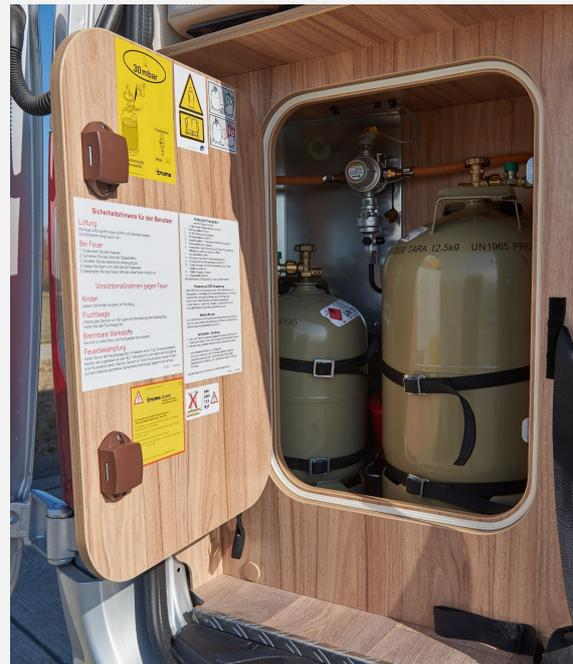
Abgeschlossener Gaskasten mit Entlüftung, Warnhinweisen, Crashesensor, Eisex und DuoControl: vorbildlich, aber nicht alles seriennmäßig. (Foto: ADAC/Uwe Rattay)
