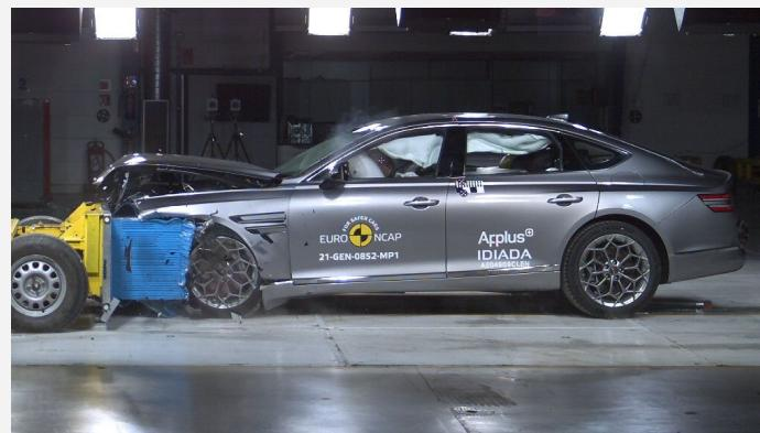
Der Genesis G80 im frontalen Offsetcrash gegen die rollende Barriere mit Deformationselement (Foto: Euro NCAP)
