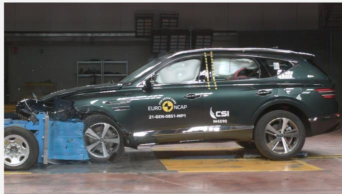
Der Genesis GV80 im frontalen Offsetcrash gegen die rollende Barriere mit Deformationselement (Foto: Euro NCAP)
