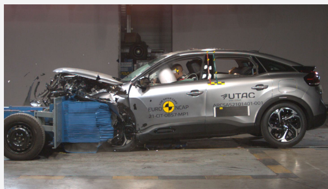
Der Citroen C4 im frontalen Offsetcrash gegen die rollende Barriere mit Deformationselement (Foto: Euro NCAP)
