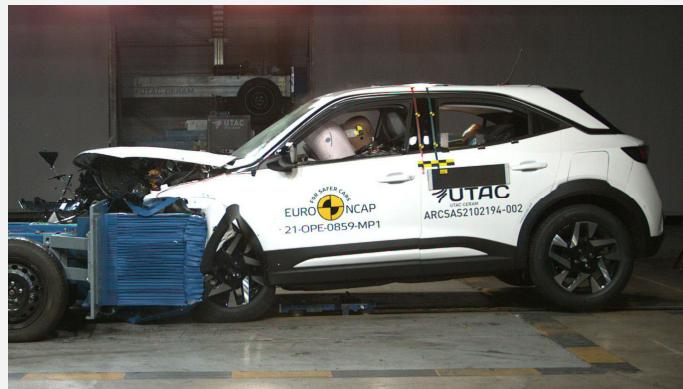
Der Opel Mokka im frontalen Offsetcrash gegen die rollende Barriere mit Deformationselement (Foto: Euro NCAP)
