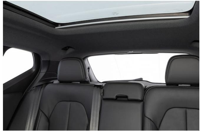
Die Sicht nach hinten wird durch breite Dachsäulen und die Kopfstützen im Fond eingeschränkt. Letztere lassen sich jedoch elektrisch abklappen.
