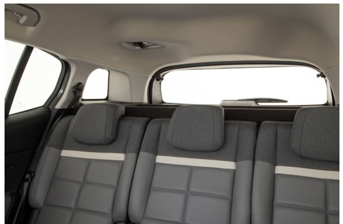
Die sehr breiten Dachsäulen schränken die Sicht erheblich ein.
