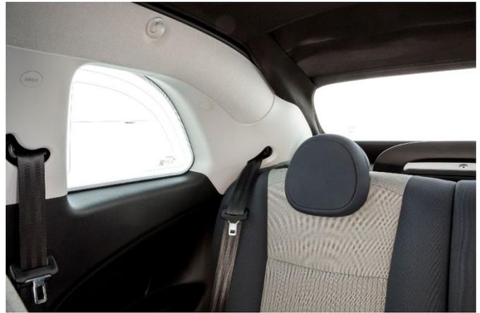
Die breiten C-Säulen und die relativ kleine Heckscheibe verhindern eine gute Sicht nach schräg hinten.
