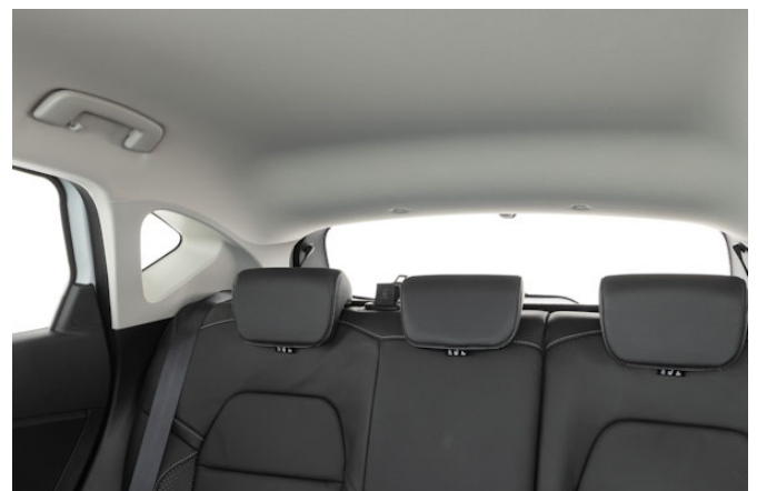
Die breiten Dachsäulen und die nicht versenkbaren Kopfstützen behindern die Sicht nach hinten stark.
