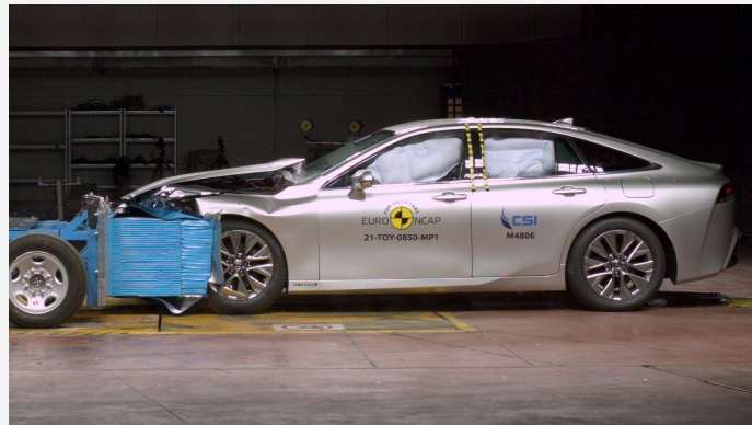
Der Toyota Mirai im frontalen Offsetcrash gegen die rollende Barriere mit Deformationselement (Foto: Euro NCAP)
