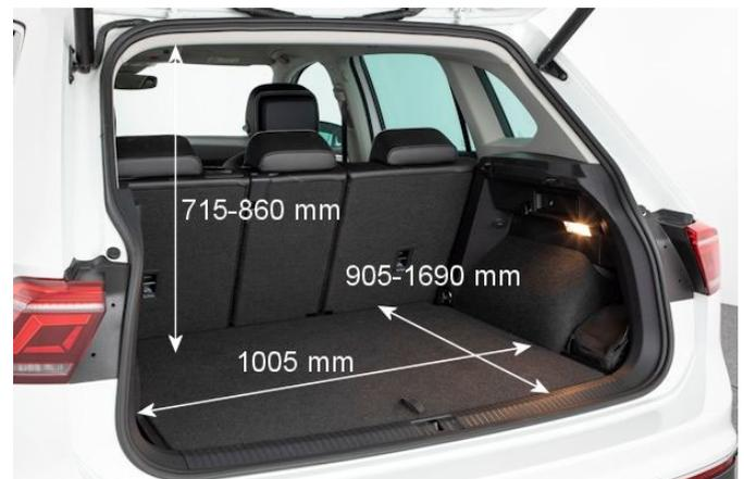
Mit 350 l Volumen bietet der Kofferraum des eHybrid um 50 l weniger Platz für das Gepäck als die herkömmlich angetriebenen Varianten.
